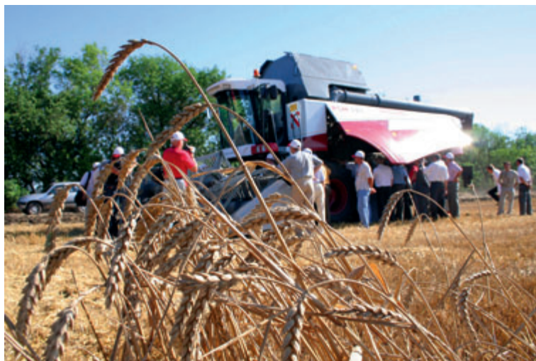
Роторный комбайн РСМ-181. Производительность на 30% выше, чем Agros-530. Испытания завершены, начало серийного производства — 2009 год. Аграрии ждут его с большим интересом
