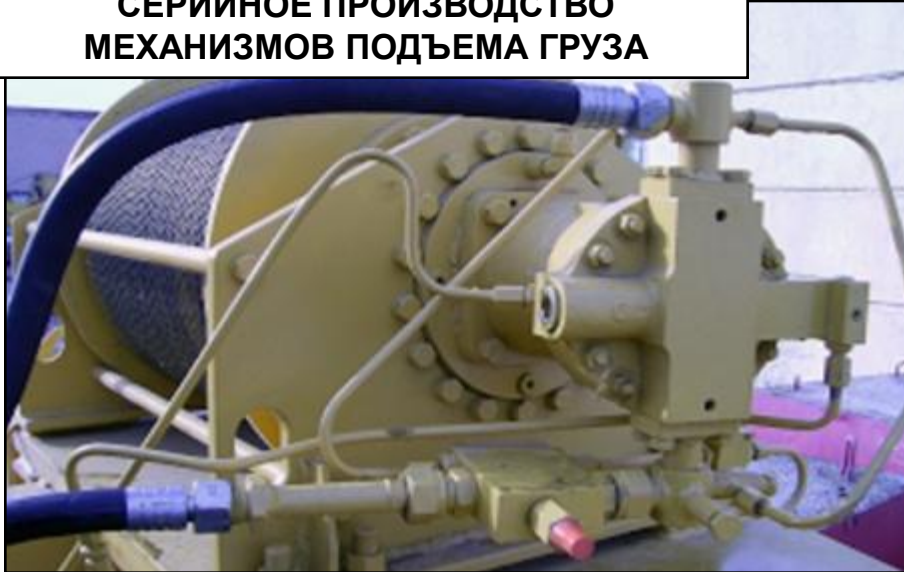
ПРОЕКТ ПЛАНЕТАРНОГО РЕДУКТОРА ЛЕБЕДКИ ПОДЪЕМА ГРУЗА
